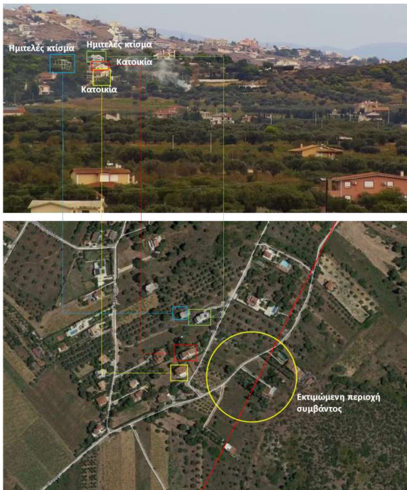
Εικόνα 7. Εξεύρεση θέσης συμβάντος (γεωεντοπισμός) με συνδυασμό μίας σκόπευσης και χρήσης ανθρωπογενών στοιχείων τοπίου (κτίσματα).
